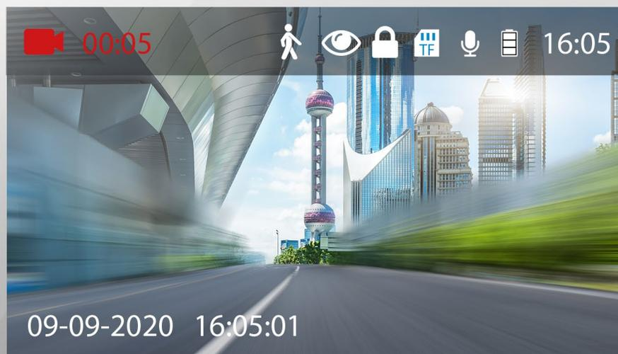
Информативный IPS-дисплей видеорегистратора **iBOX X-Zoom Dual** с диагональю 4,3 дюйма позволяет производить настройки устройства и отображает всю информацию, необходимую для контроля видеозаписи.
